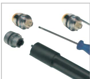
Die Betätigungselemente werden auf der Rückseite der Einbaufäche durch einen schraubbaren Befestigungsring montiert. Der Befestigungsring kann mit einem speziellen Montageschlüssel aber auch durch einen Standard-Schraubendreher angezogen werden.
