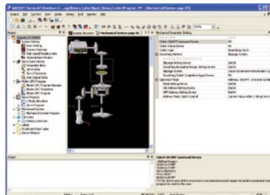
Programmierung über eine virtuelle mechanische Systemumgebung
